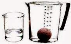
الشكل ٢٣: عندما مسقط الكرة في الإناء الأكبر المملوء بالماء أزاحت بعضه، وقد تم جمع الماء المزاح في الإناء الأصغر. فواصل ماذا تعلم عن وزن الماء المزاح وحجمه؟
