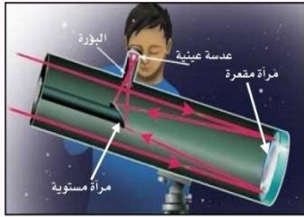
في المنظار الفلكي الكاسر تقوم مرآة مقعرة بتجميع الضوء لتكوين صورة تقع بين البؤرة الأصلية والمركز البصري للعدسة العينية.
