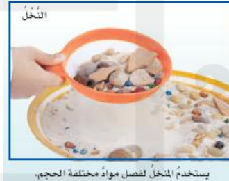
يستخدم التخلّ لفصل مواد مختلفة الحجم.
