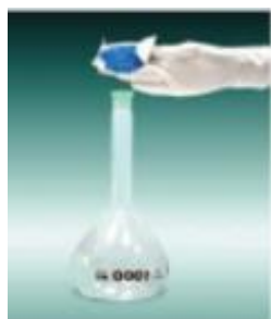
خطوة 1 تقاس كتلة المذاب وتضاف إلى دورق حجمي مناسب.
