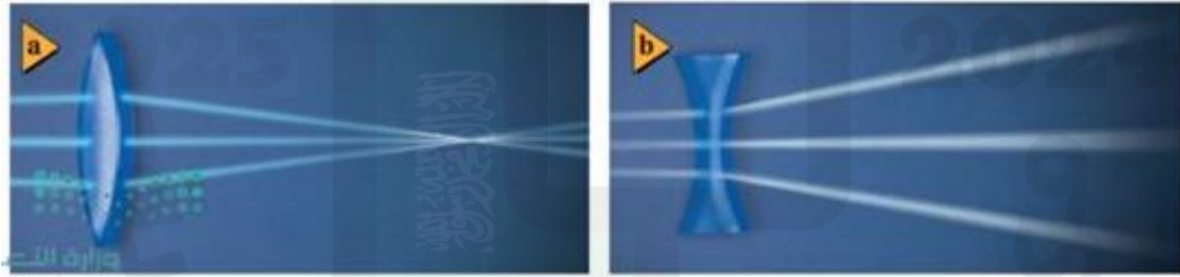
الشكل ٩-٣ تعمل العدسة المحدبة على تجميع أشعة الضوء (a) أما العدسة المقعرة فتفرق أشعة الضوء (b)
