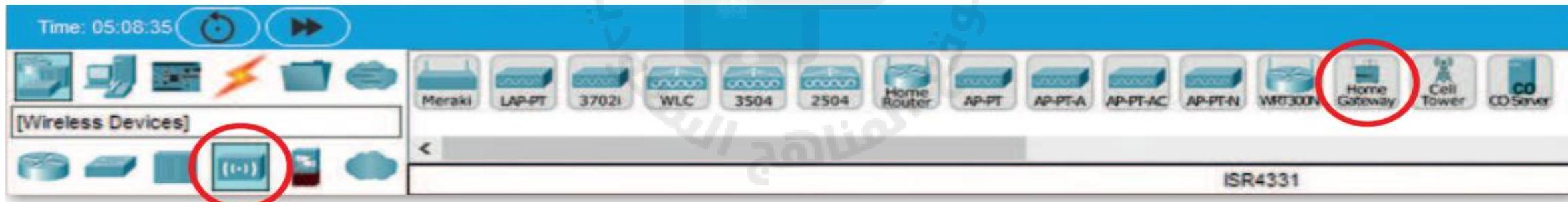
المودم هو جهاز يوصل جهاز الحاسوب أو جهاز توجيه بالإنترنت من خلال استخدام الكابلات، ويتلقي المودم معلومات من مزود الخدمة (ISP) عبر خطوط الهاتف أو الألياف الضوئية أو الكابل المحوري ويتحولها إلى إشارة رقمية.
