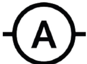
4- ما رمز الجهاز المستخدم لقياس شدة التيار الكهربائي؟
