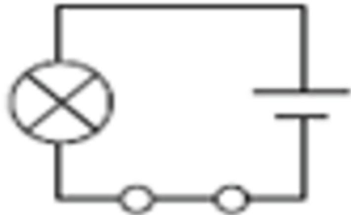
[السؤال الثالث/ أ.] يحتوي مخطط الدائرة الكهربائية في الشكل المجاور ثلاثة أخطاء أكمل المخطط بحيث يضيء المصباح ونستطيع قياس شدة التيار الكهربائي.
