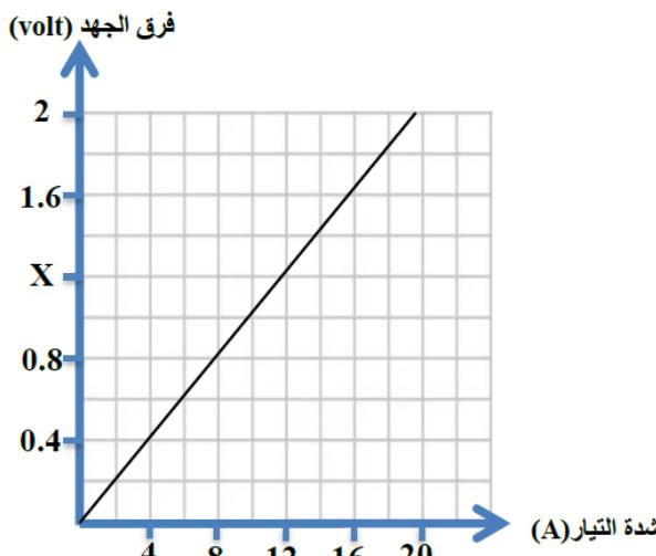
6- أجرى طالب تجربة لدراسة العلاقة بين شدة التيار وفرق الجهد الكهربائي وقام برسم المنحنى البياني الموضح في الشكل التالي :
