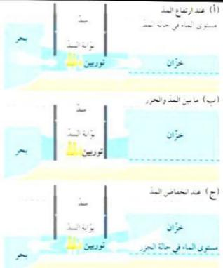
الشكل ٢-١١ (أ) فتح بوابات المد، ليتدفق الماء إلى الخزان عند ارتفاع المد، وبالتالي تُشغل التوربين. (ب) إغلاق بوابات المد، لمحارب الماء خلف الحاجز. (ج) فتح بوابات المد واطلاق الماء عند انخفاض المد، لتشغيل التوربين.
