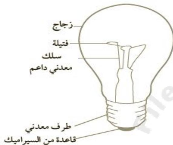
١. أ. اذكر ثلاثة أجزاء من المصباح الكهربائي مصنوعة من مواد موصولة للكهرباء. بالنسبة لكل جزء، اذكر لماذا يجب أن يوصل بالكهرباء لكي يعمل المصباح الكهربائي.
