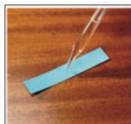
الصورة ٥-٤ تغير لون ورقة كلوريد الكوبالت (III) اللامائي عند إضافة الماء.
