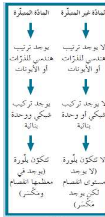
شكل 49 مخطط يوضح الفرق بين المادة المتبلورة والمادة غير المتبلورة.
