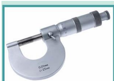
(شكل 4) يستخدم جهاز الميكرومتر في قياس الأطوال الصغيرة جدًا.
