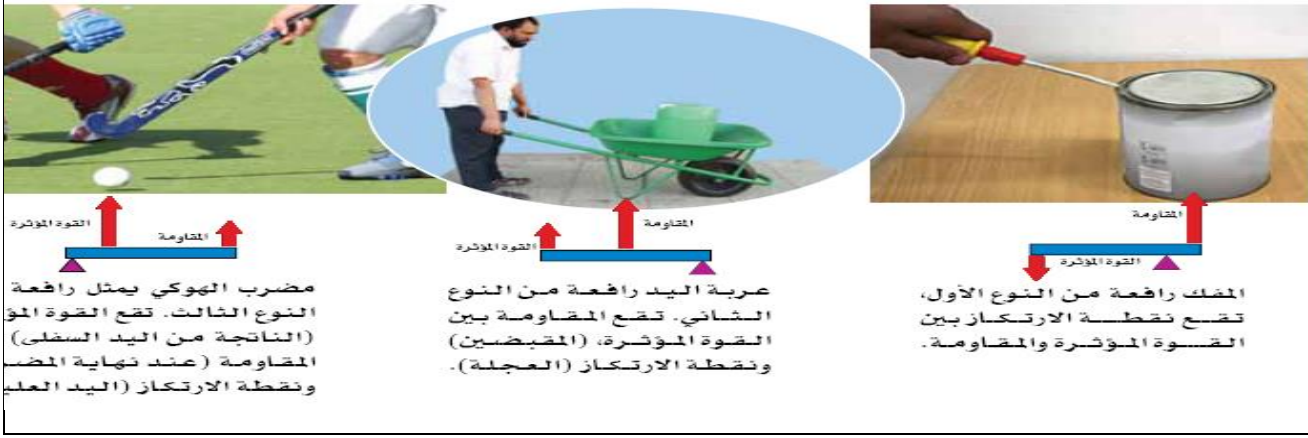
الشكل ٨ تصنيف الرافعة تبعاً لموضع كل من القوة المؤثرة والمقاومة ونقطة الارتكاز.
