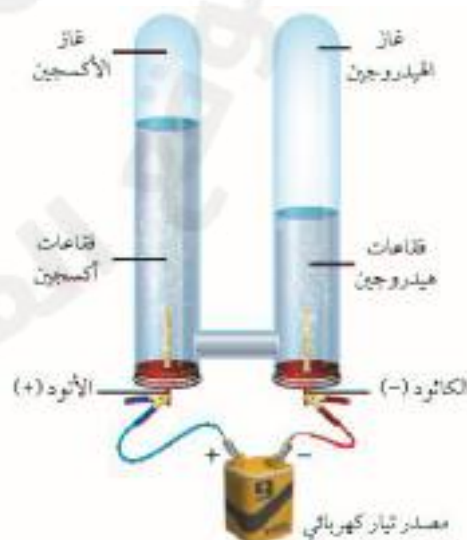
التحليل الكهربائي للماء
