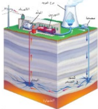
■ الشكل 23: تحول محطات الطاقة الحرارية الأرضية الطاقة الحرارية الأرضية إلى طاقة كهربائية. ويتحول الماء إلى بخار بفعل الضغط الساخن، ثم يسحق البخار إلى التوربينات لتوليد الكهرباء.
