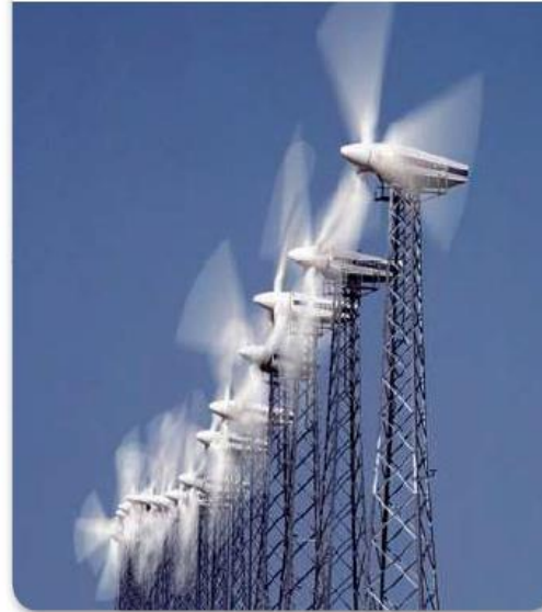
■ الشكل 22 تتحوّل طاقة الرياح إلى طاقة كهربائية عندما تُشغّل المروحة الدائرة المولّد.
