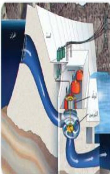
الشكل 19: تحويل طاقة الوضع الجذبية للماء الموجود خلف السد إلى طاقة كهربائية في إحدى محطات الطاقة الكهرومائية.
