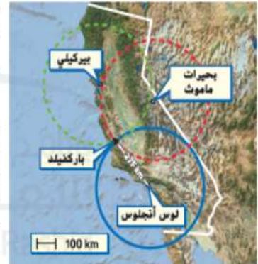
الشكل 6 محطة قياس الزلازل توفر سجلات الزلازل المعلومات اللازمة لتحديد موقع مركز الزلزال السطحي.
