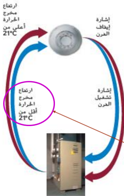
الشكل 14 تعمل المدفأة أو تتوقف عن العمل بناءً على العلاقة بين درجة حرارة الغرفة التي يتم استشعارها والنقطة المرجعية.
