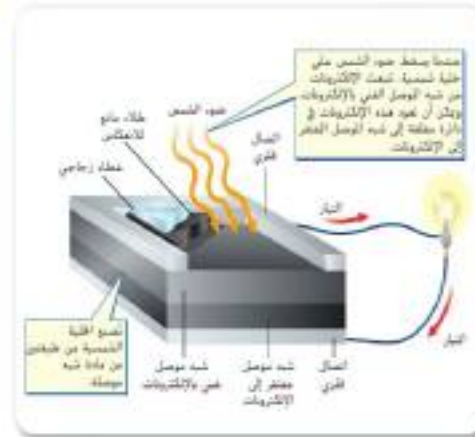
الشكل 18 تسطع الطاقة الإشعاعية الناتجة عن ضوء الشمس على سطح الخلية الشمسية فتسير الإلكترونات وتتدفق عبر الدائرة الكهربائية. حثّه جهازين يعملان بعمليات الطاقة الشمسية.
