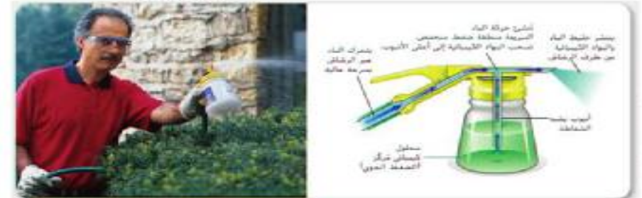
الشكل 17 يوضح الخرطوم المنتهي برشاش مبدأ برنولي.
