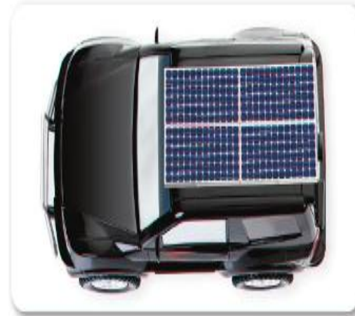
الشكل 17 تحول الخلايا الكهروضوئية الطاقة الإشعاعية إلى طاقة كهربائية. لبعض المركبات ألواح كهروضوئية اختيارية مصنوعة من خلايا شمسية تستخدم لتبريد السيارة من دون استخدام المحرك.
