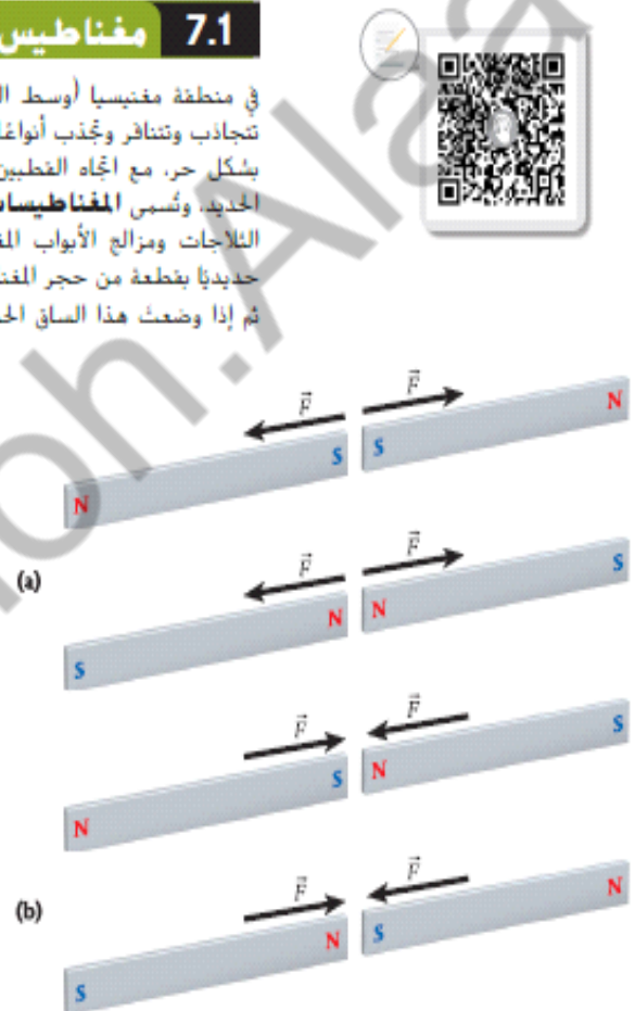
الشكل 7.2 (a) الأقطاب المغناطيسية المتماثلة تتنافر، (b) الأقطاب المغناطيسية المختلفة تتجاذب.
