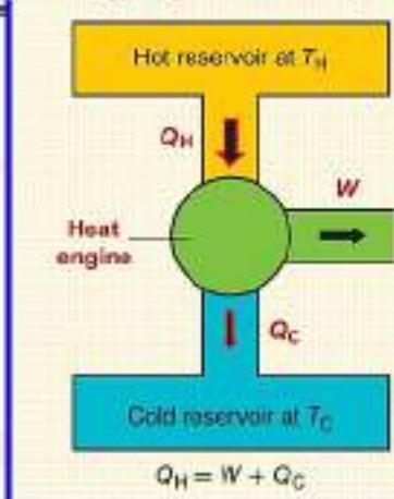
هو جهاز قادر على تحويل الطاقة الحرارية بشكل مستمر إلى طاقة ميكانيكية .
