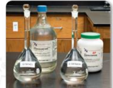
الشكل 17 البطاقة على زجاجة حمض ذوي أو قاعدة قوية تدرك على تركيز أيونات الهيدروجين أو أيونات الهيدروكسيد في المحلول. وذلك لأنه، في المحلول، توجد الأحماض والقواعد عيوناً كأيونات. حدد [H^+] في دوارق HCl و [OH^-] في دوارق NaOH.
