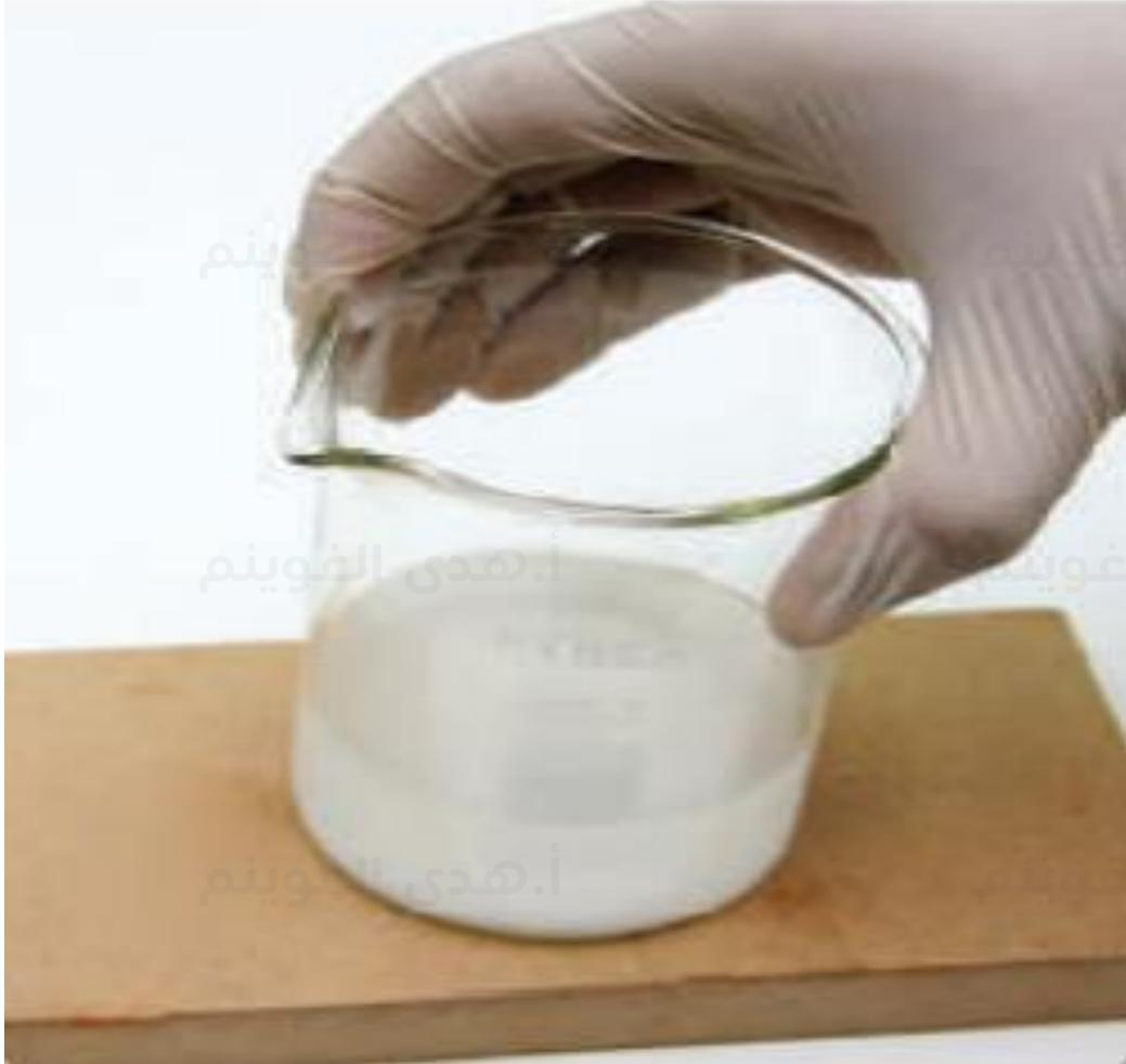
الشكل 2-6 في هذا التفاعل الماص للحرارة يمتص خليط التفاعل كمية كافية من الطاقة من الماء الذي يبلل اللوح ومن اللوح نفسه، فتتخفض درجة حرارة الماء حتى التجمد فيمسك اللوح بالكأس.
