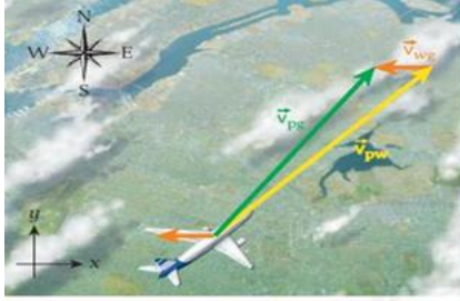
الشكل 3.19 السرعة المتجهة لطائرة بالنسبة إلى لرياح (باللون الأصفر). والسرعة المتجهة للرياح بالنسبة إلى الأرض (باللون البرتقالي). والسرعة المتجهة المحصلة للطائرة بالنسبة إلى الأرض (باللون الأخضر).
