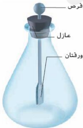
الشكل 7 ورقتا الرقائق الفلزية في كشاف كهربائي متعادل تتدليان معا على نحو حر.
